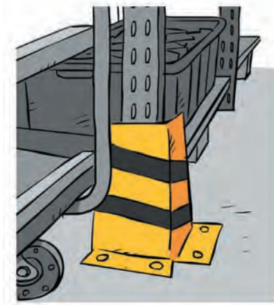
Protección de puntales con colores de seguridad
