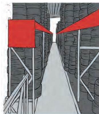
Altura máxima en almacenamiento en estanterías 4,4 m
