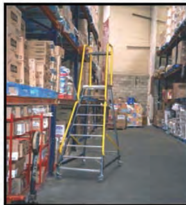
Medio de acceso seguro mediante escaleras móviles
