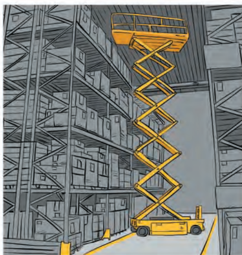
Acceso seguro mediante una PEMP
