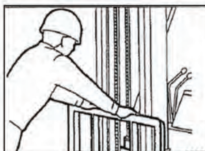
El respaldo (deformación, grietas...)
