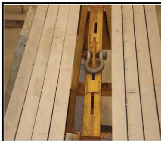
Caballete transportable mediante orejeta de elevación y grillete
