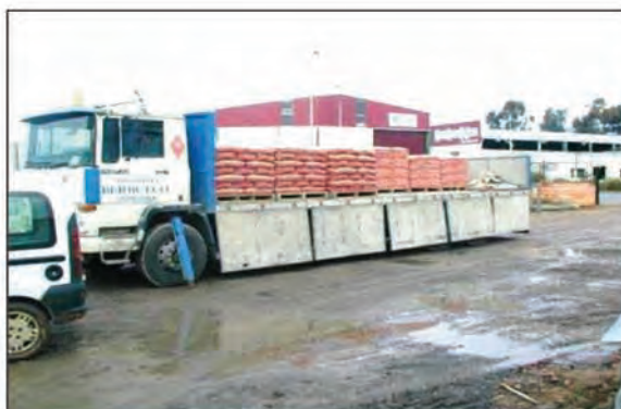
Presencia de vehículos ajenos en zona de carga y descarga sin delimitar
