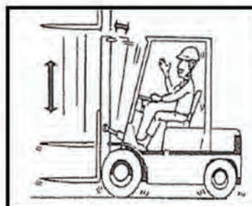
Recorrido e inclinación del mástil
