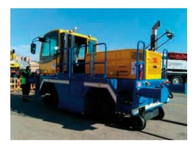
Equipo de menor potencia que la locomotora adaptada para la conducción sobre vías de ferrocarril, así como carreteras.
