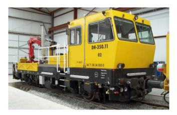
Máquina ferroviaria dotada, por lo general, de grúa de carga y descarga así como de castillete de elevación vertical para realizar trabajos en altura.
