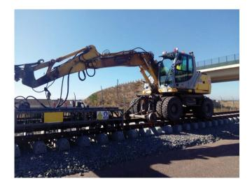
Retroexcavadora dotada de diplory para circular sobre la vía, dotada de diferentes útiles destinados a la manipulación de elementos de la vía (cupones de carril, traviesas, materiales...).
