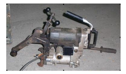
Equipo de perforación destinado a realizar orificios pasantes en el alma de carril y en las traviesas de madera.
