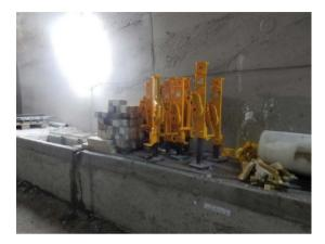
Equipo manual de izado de carril y/o traviesa mediante un sistema de polea, piñón y cremallera.
