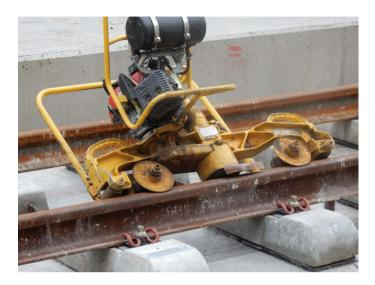
Equipo compuesto por diversos elementos de amolado y pulido giratorios situados sobre una estructura portátil que es empujada por el personal. Permite eliminar rebabas y defectos superficiales en carril, acabado de soldaduras...
