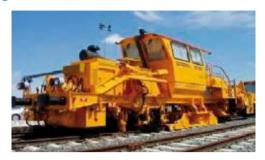
Máquina destinada a la conformación geométrica de la banqueta de vía mediante la utilización de unos aparejos de empuje móviles (cuchillas y arados), así como al barrido de exceso de balasto en la zona superior de traviesas y carril.
