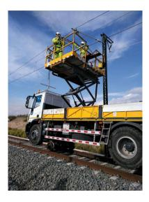
Camión de carga y descarga dotado de diplory para circular sobre la vía. Dispone de grúa de carga y descarga de material con posibilidad de instalar plataforma de elevación de personal, y, adicionalmente, está dotado de castillete de elevación vertical de personal.
