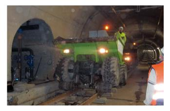
Dúmper de movimiento de tierra dotado de diplory para circular por la vía destinado a tareas de carga y descarga de balasto, trabajos de limpieza de superestructura, etc.
