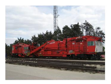
Máquina dotada de un elemento de arrastre continuo destinado a la retirada de balasto bajo la línea de las traviesas, y que acoplada a un conjunto de tolvas, es utilizada para el cribado y depuración de la banqueta ferroviaria.
