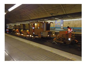
Máquina ferroviaria dotada con elementos de pulido y limpieza de carril destinada a la corrección de imperfecciones y conformado geométrico de la vía.
