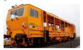
Vehículo ferroviario que mediante un sistema de transmisión dinámica de aceleración y frenado contribuye a la estabilización de la plataforma ferroviaria mediante pasadas sucesivas sobre la superestructura finalizada.
