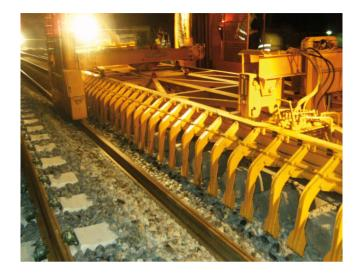
Elemento formado por pórticos metálicos que se desplaza por la vía, sobre el propio carril o mediante orugas y cuya principal función es la manipulación de elementos de vía (traviesas, carril, parejas de vía...).
