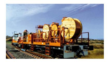
Conjunto formado por locomotora y tren de trabajos, consistente en diversas plataformas portabobinas de posicionamiento y tendido de conductor de electrificación.
