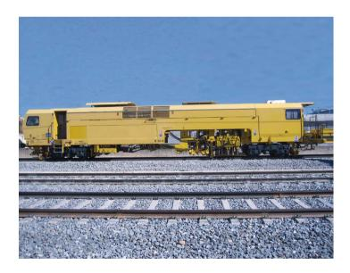
Máquina ferroviaria utilizada para la nivelación y alineación de la vía, dotada de bates vibrantes que se introducen en la capa de balasto y lo compactan bajo las traviesas paradotar a la vía de una posición exacta en planta y alzado.
