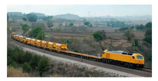
Composición ferroviaria formada por el conjunto de locomotora y tolvas de transporte de material, generalmente balasto, utilizada en las operaciones de extendido de banqueta de vía.
