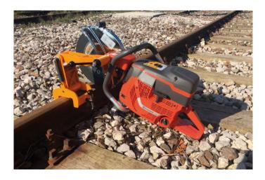
Máquina radial de corte de carril que dispone de un elemento de fijación al carril a modo de brazo.
