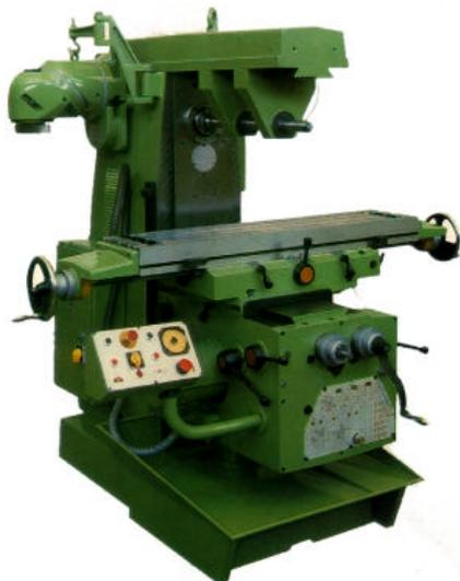
Figura 8.- Fresadora horizontal
