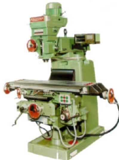
Figura 9.- Fresadora vertical
